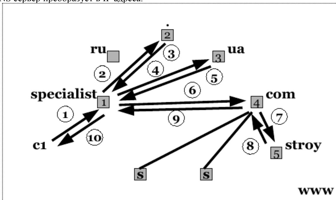
Например, DNS сервер, отвечающий за домен specialist.ru предназначен для преобразования имен компьютеров, входящих в этот домен. Если посмотреть на схему, то становится понятно, что этот DNS сервер может преобразовать имена компьютеров: office.specialist.ru, www.specialist.ru, ftp.specialist.ru. Компьютеры c1.office.specialist.ru и c2.office.specialist.ru относятся к другому домену и поэтому их имена не будут преобразованы этим DNS сервером.
